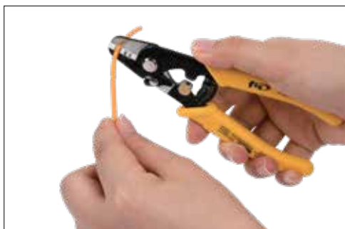
Furo maior: corta a camada protetora externa da fibra de 2 a 3 mm
