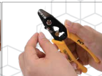
Furo menor: decapa o revestimento da fibra de 250µm a 125µm
