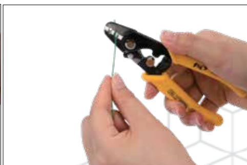
Furo médio: decapa a capa protetora de borracha branca macia de 900µm a 250µm
