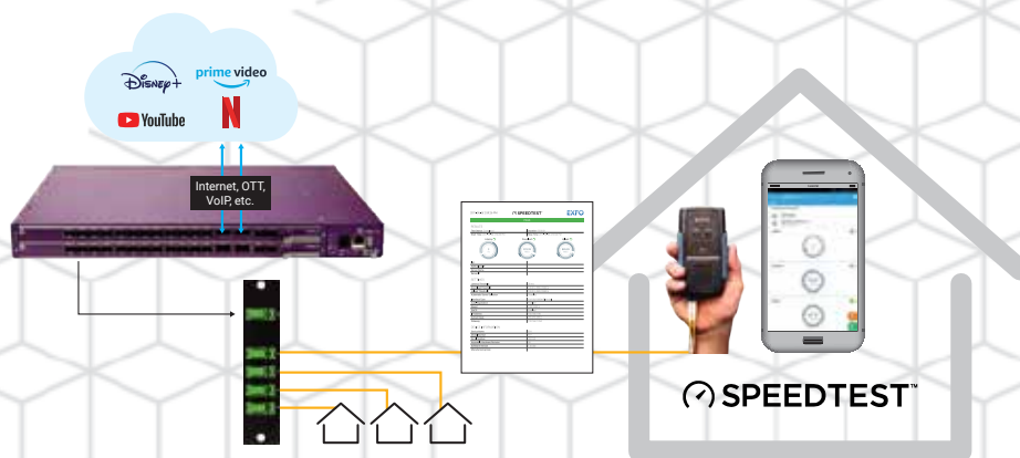
Teste de velocidade sobre GPON ou XGS-PON
